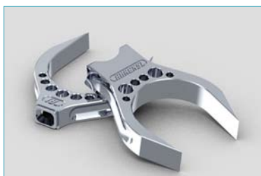
Задняя вилка велосипеда Арех, разработанная в Pro/ENGINEER.
