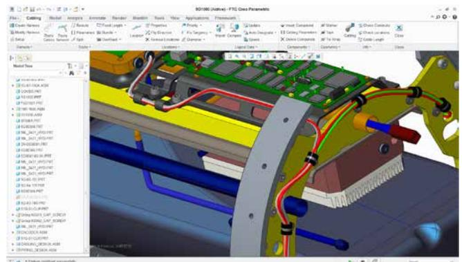
Автоматизированные возможности проектирования кабельных систем позволяют легко перемещать компоненты и разъемы без ручного изменения маршрута проводов и кабелей.
