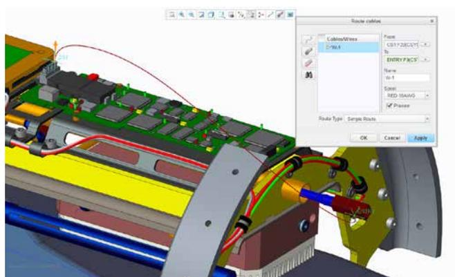
Соединения можно определять вручную или исходя из логической информации. Creo PCX автоматически генерирует простой маршрут, с помощью которого пользователь может быстрее найти оптимальный.
