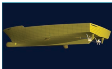
Модель корпуса судна, готовая к самоходным испытаниям.
