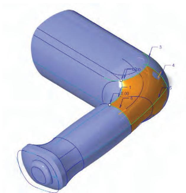
Усовершенствованные инструменты построения поверхностей, используемые в Creo ISDX, позволяют создавать высококачественные поверхности при наличии более чем 4 границ.
