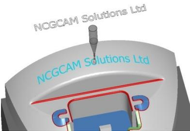
Обработка Вдоль Границы, создает обработку вдоль открытого или замкнутого профиля границы. Можно использовать отрицательный припуск для обработки поверхности и углы контакта. Обработка Вдоль Границы может использоваться для обработки питателей пресс-форм или применяться для гравировки, используя шрифты True Type. Доступность шрифтов будет зависеть от операционной системы Windows.
