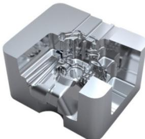
**NCG CAM** полностью защищает деталь от зарезов инструментом и хвостовиком. NCG CAM обеспечивает защиту от зарезов также и при 5-ти координатной обработке (3+2 оси), что позволяет безопасно обрабатывать зоны недоступные для стандартного 3-х осевого фрезерования.
