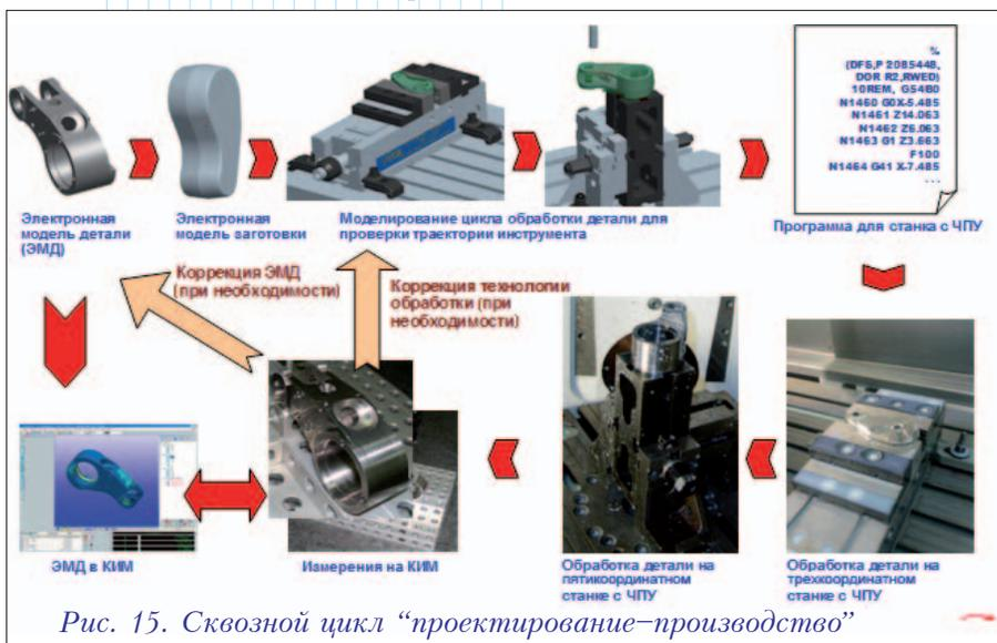
Рис. 15. Сквозной цикл “проектирование–производство”
