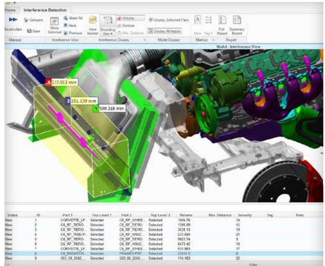
Обнаружение и анализ столкновений с помощью дополнительного модуля Creo View Interference Analysis.
